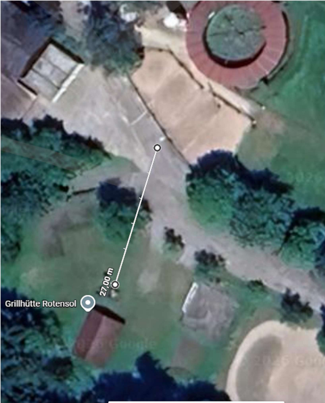
Luftbild Löschwasser zum nächsten Hydranten
